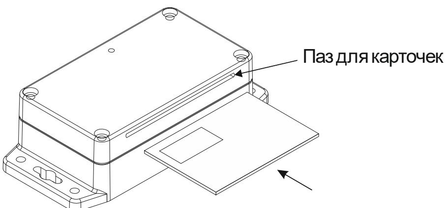
Рис. 3.2. Вставка карточки в паз считывателя
