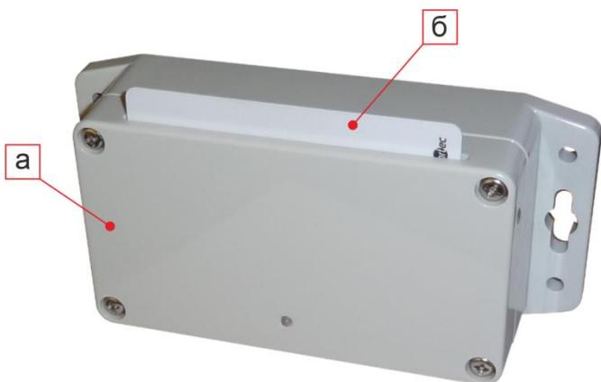
Рис. 1.1. Система идентификации оператора: а - считыватель MF карточек, б – карточка MF
